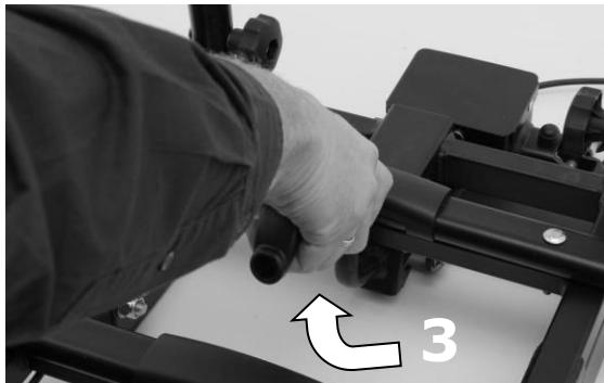
Med en hand på cyklerne eller U-bøjlen og den anden på tilt-funktion-håndtaget, som du trækker op imod lodret for at låse funktionen op. (3). Vip forsigt holderen bagud.
